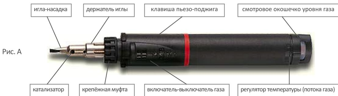
**Шаг 3.** Температуру и поток газа можно регулировать путём поворота регулятора на конце прибора, а также путём своевременного выключения клавиши подачи газа. Для достижения необходимой температуры не требуется накаливать катализатор до красна, достаточно поставить регулятор температуры на средние. После набора необходимой температуры, в т.ч. и во время работы, нужно перекрывать вентиль потока газа сдвигом выключателя газа, чтобы не допускать подгорание расплавляемого материала.
