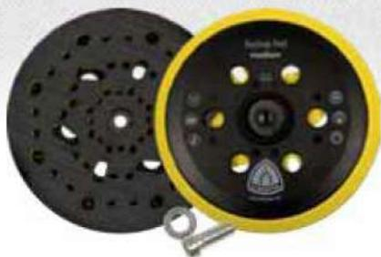
**Преимущества:** Очень хорошее сцепление со всеми дисками на велькро-основе за счет тонкой, термостойкой, самоцеппляемой основы - Подходит для всех стандартных типов отверстий, в том числе для сеткообразных и мульти-перфорированных типов - Самоцеппляемый опорный диск для моделей BOSCH GEX-150
