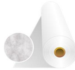
Полиэстеровая подложка, компенсирующая напряжения приклеенного паркета. Применяется в качестве армирующего и компенсирующего слоя при укладке паркета на технически проблемные старые поверхности сухих цементных, ангидритных стяжек, стяжек из литого асфальта, с небольшими трещинами шириной до 0,5 мм.
