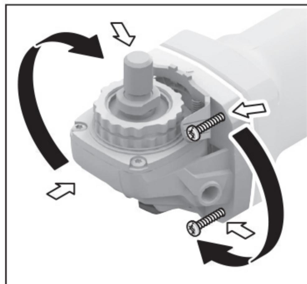
Корпус редуктора может поворачиваться с интервалом в 90°. Этим выключатель может быть установлен в удобное для работы положение, например, для левши.
