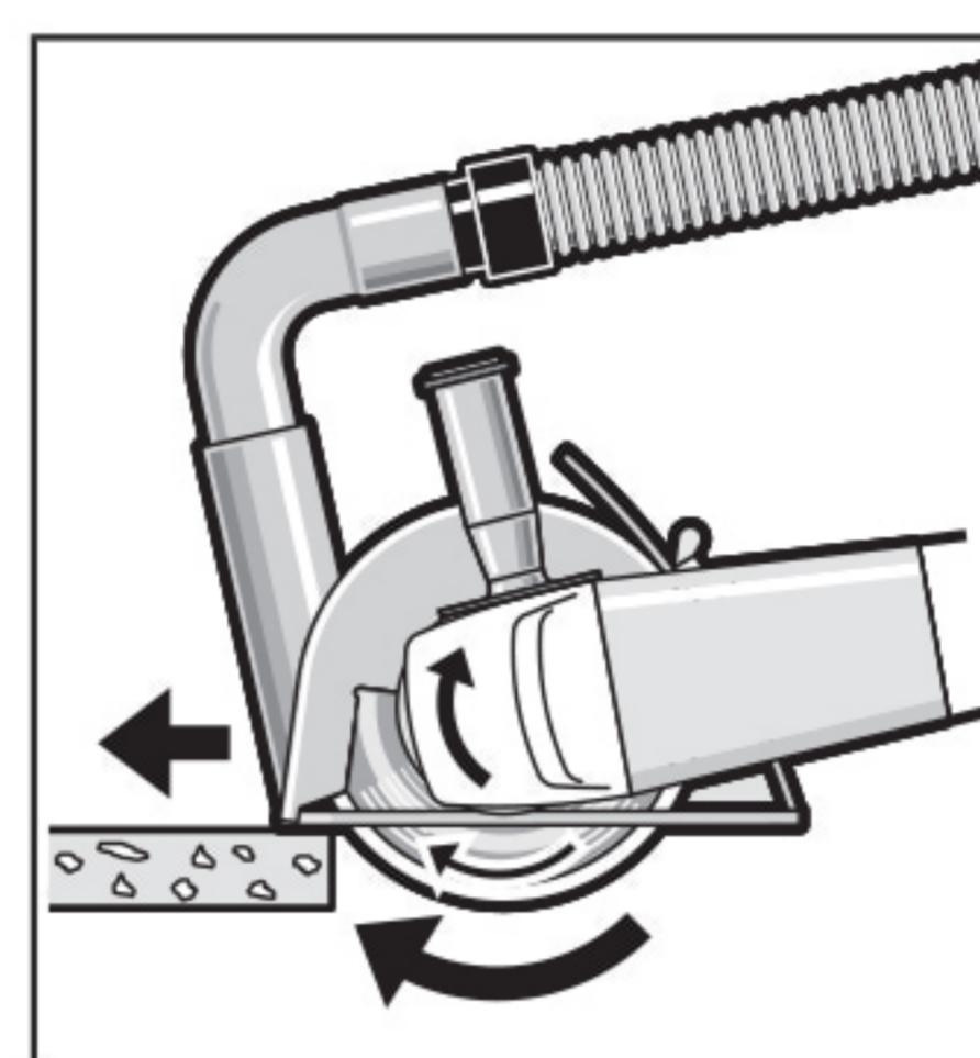
Включите электроинструмент и приставьте переднюю часть направляющих салазок к обрабатываемой заготовке. Ведите пневматический инструмент с равномерной, рассчитанной на обрабатываемый материал подачей.
