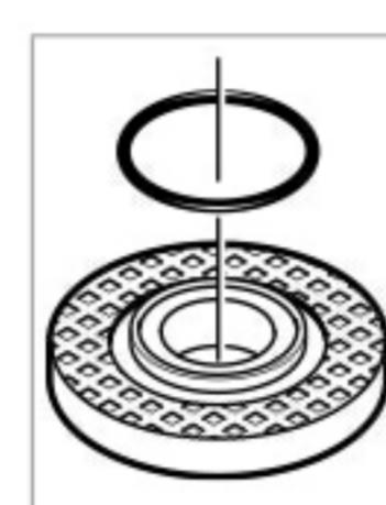
**Опорный фланец шлифовального шпинделя M 14:** На опорном фланце (9) вокруг центрирующего буртика находится пластмассовая деталь (кольцо круглого сечения).
