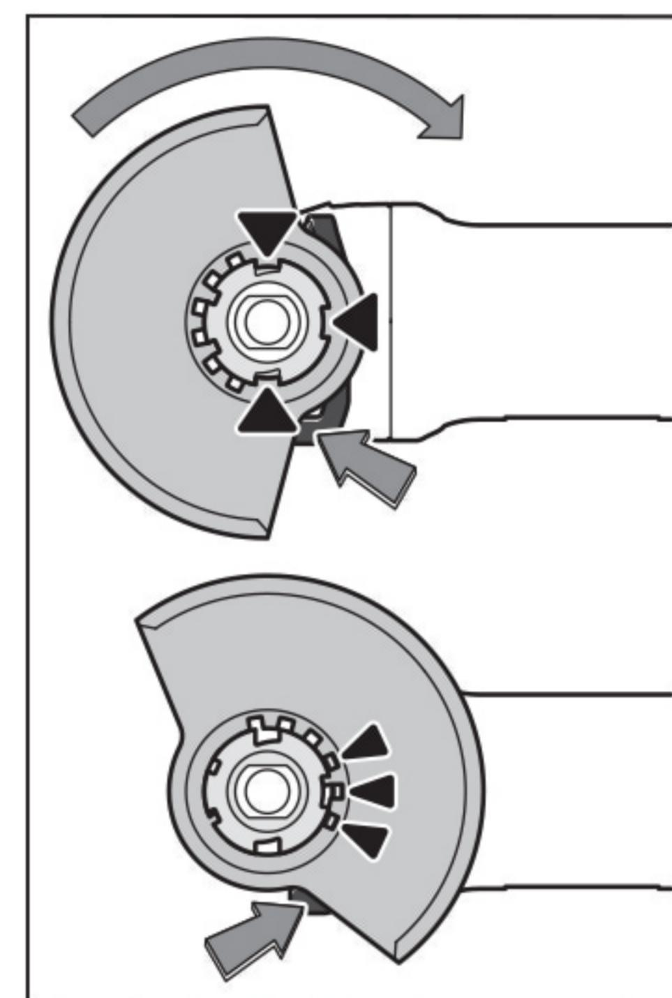
Положите защитный кожух (8) на крепление на электроинструменте так, чтобы кодирующие кулачки защитного кожуха соответствовали креплению. При этом нажмите и держите нажатым рычаг разблокировки (1).
