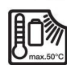
**Защищайте аккумуляторную батарею от высоких температур, напр., от длительного нагревания на солнце, от огня, грязи, воды и влаги.** Существует опасность взрыва и короткого замыкания.
