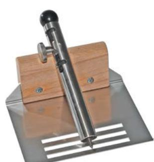
Прибор Ri Ri для определения твёрдости поверхности стяжек.
