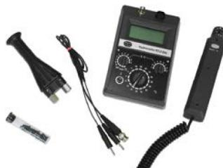
Комбинированный электронный прибор для определения влажности древесины, стройматериалов и воздуха, а также температуры.
