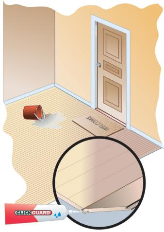
В местах постоянного воздействия влаги (прихожая, кухня и т.п.) при укладке используйте силикон. Нанесите его на фибровую часть замка. Присоедините доску. Подождите 15-20 минут. Удалите излишки силикона.
