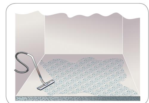
**Всегда существует опасность повышенной влажности пола, на который укладывается покрытие. Поэтому необходимо обеспечить влагозащитный барьер!**
