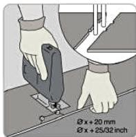
Вокруг отопительных труб, саморезов и т.п. необходимо сделать температурный зазор не менее 10-12 мм. Покрытие должно свободно двигаться во всех направлениях. Отметьте на планке места труб, отпишите кусок планки под углом 45° к их осям. Установите отпиленную часть на место и защитите зазор специальной накладкой.
