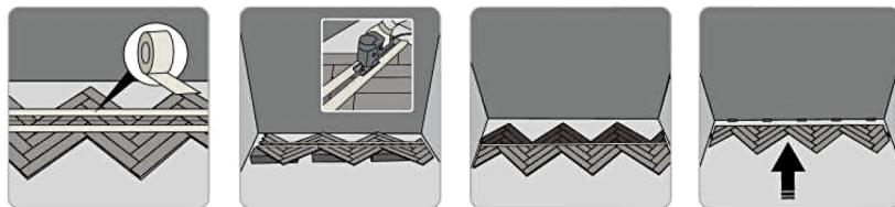
Продолжайте укладку следующих рядов, устанавливая сначала А-планки, а затем В-планки. Фиксируйте температурный зазор распорными клиньями по периметру помещения. Клинья также не позволяют покрытию двигаться во время укладки. Удалите их после установки покрытия.
