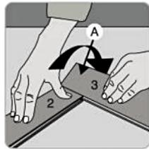
При измерении длины ряда и размера последней планки в ряду учитывайте зазор расширения по бокам. Начните первый ряд с планок А. Расположите их под углом 45°, а затем соедините их с В-планками, чтобы закончить первый ряд.
