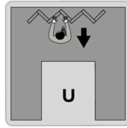
Продумайте, как вы будете располагать направление укладки в вашем помещении, чтобы выбрать от какой стены начинать монтаж. Измерьте помещение чтобы распределить планки равномерно. Обязательно учитывайте отступ от стены для температурного (расширительного) зазора не менее 8 мм! Для L- или П- образных комнат рекомендуем сделать чертежи.
