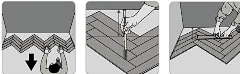
Сдвиньте уложенные ряды в направлении стены и наметьте линию разреза повсему ряду, чтобы выровнять покрытие и "подогнать" его по стене.
