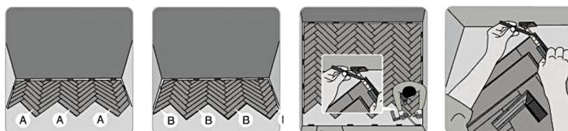
Положите планку торцевым замком к стене. Отметьте измеренное расстояние и начертите линию под углом 45°. Отпишите планку и установите её. Рекомендуем использовать клей для крепления небольших частей планки.
